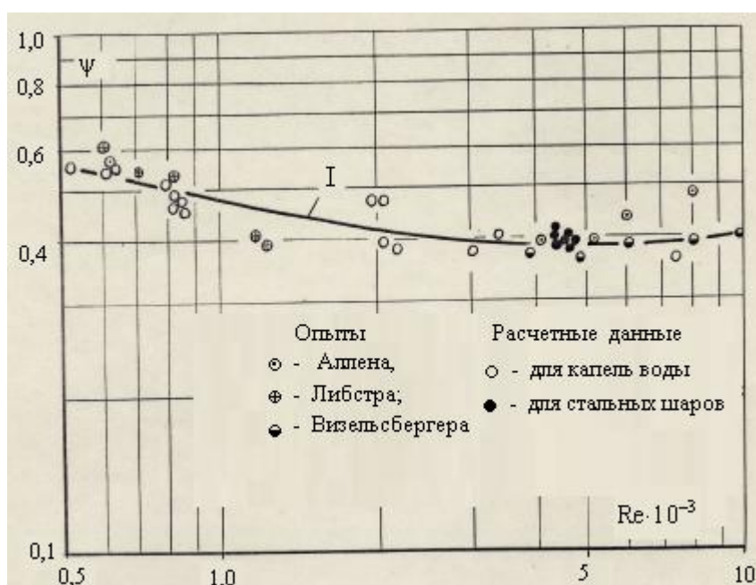
Рис. 2.19. Изменение коэффициента аэродинамического сопротивления падающих шарообразных частиц при увеличении числа Рейнольдса (I – кривая Рэлея)
